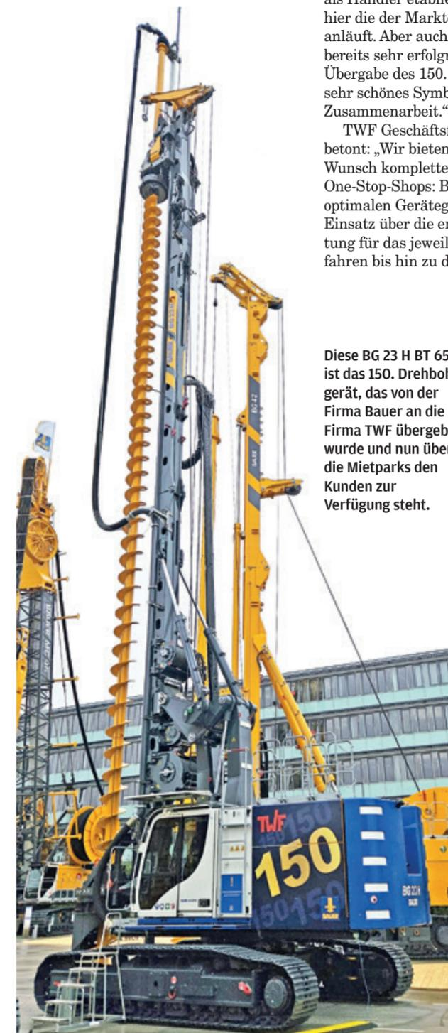
Diese BG 23 H BT 65 ist das 150. Drehbohrgerät, das von der Firma Bauer an die Firma TWF übergeben wurde und nun über die Mietparks den Kunden zur Verfügung steht.
